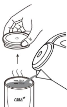
Откройте крышку, залейте холодную (только PCM03) или горячую воду, закройте крышку. Не допускайте выхода за пределы шкалы MAX.
