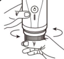
Вкрутите запорную камеру ⑤ в основной корпус. (Осторожно: неплотная закрутка приведет к протечкам).
