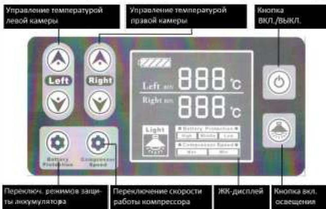
Температура охлаждения регулируется в пределах от +10°C до -18°C.
