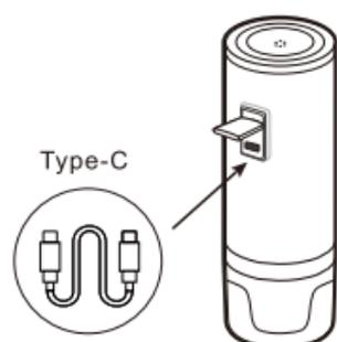
\* Пожалуйста, используйте для зарядки стандартное зарядное устройство USB 5В/2А или 5В/3А. Устройство не будет заряжаться при использовании зарядного устройства мощностью ниже 10 Вт (например, зарядное устройство Apple 5 Вт)
